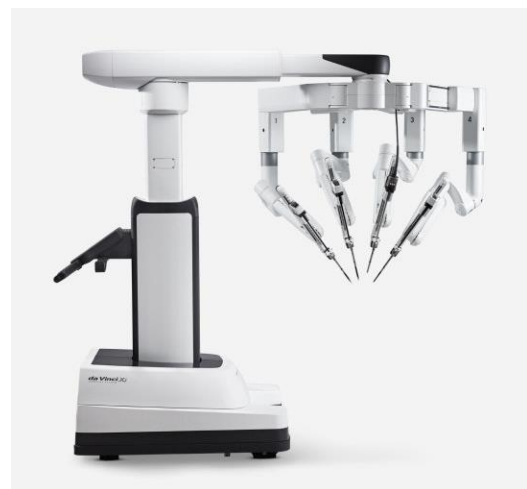
Abbildung 1: Da Vinci Xi: das weltweit am häufigsten eingesetzte roboter-assistierte Multiport-Operationssystem
